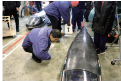
パドック内車検場で行われた公式車検。車両重量やドライバー、ライダーの装備、ブレーキ性能、後方視界（写真）など安全面の確認に重点を置いて実施されました。
