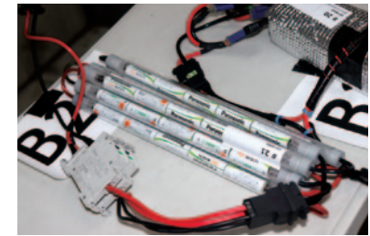
各車両に搭載される単三形乾電池「Panasonic EVOLTA」。公式車検後の走行前と競技のインターバルには専用ピット内に預けられ、オフィシャルによって保管されます。
