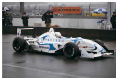
宇都宮工業高校 科学技術研究部が製作したフォーミュラEVカーのデモンが実施されました。単三形乾電池「Panasonic EVOLTA」1000本で時速35kmのパフォーマンスを発揮します。
