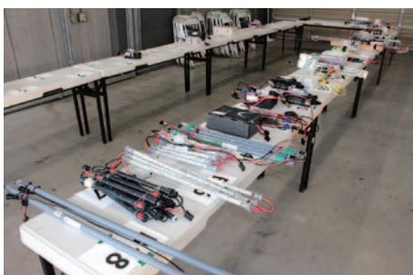
各車両に搭載される単三形乾電池〔Panasonic EVOLTA BK-3MLE〕。公式車検後の走行前と競技のインターバルには専用ピット内に預けられ、オフィシャルによって保管されます。
